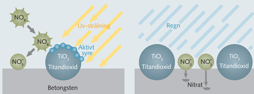
NO x -reduktionens förlopp med TiOmix®
